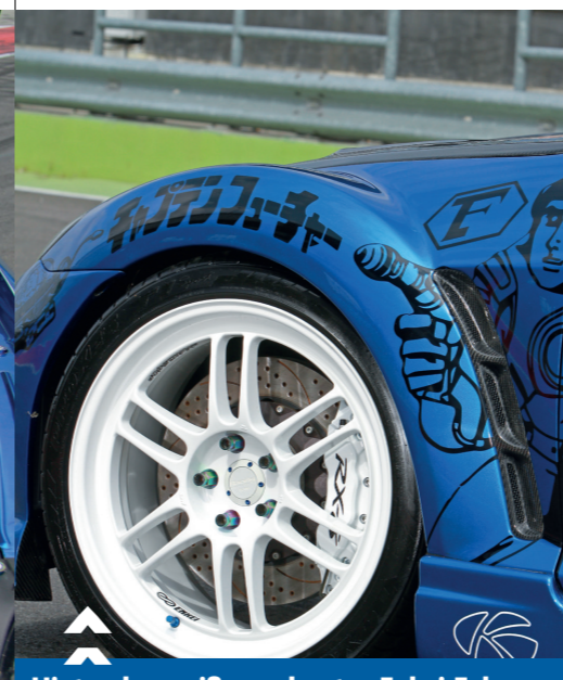
Hinter den weiß gepulverten Enkei-Felgen sitzen an der Vorderachse modifizierte K-Sport-Bremsanlagen mit 8-Kolben-Sätteln.
