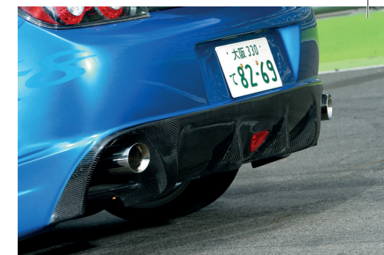
Die Seibon-Heckklappe zeigt Carbon-Gewebe und trägt einen Spezial-Ducktail.
